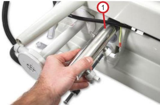
Abb. 8.1.2.5: Gehäuse UV-Entkeimung entfernen
