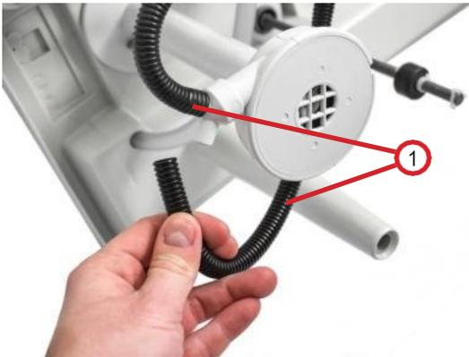
Abb. 6.3.4.4: Pumpenschläuche abziehen
