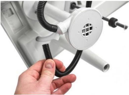
Abb. 7.4.1.5: Pumpenschläuche abziehen
