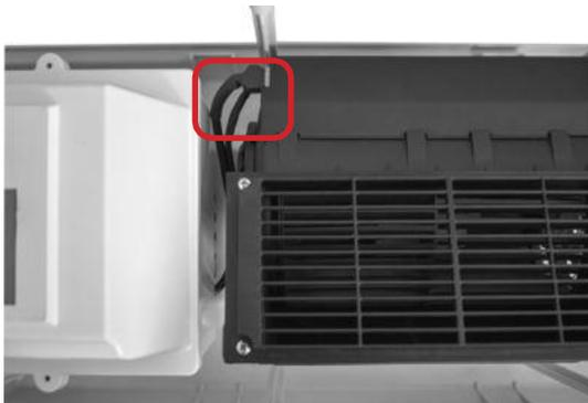
Abb. 7.4.2.6: Gebläsestecker anschließen
