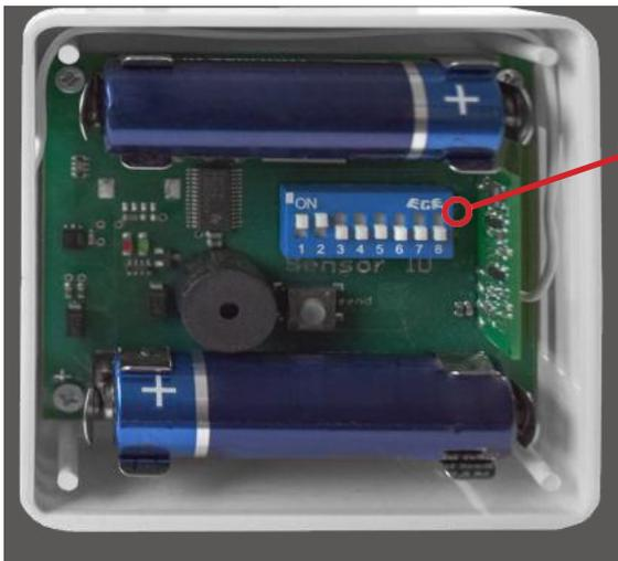
Abb. 5.6.4: Funkfeuchtesender codieren
