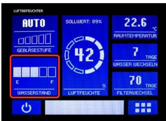
Abb. 5.1.2: Anzeige Wasserstand
