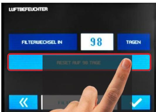
Abb. 6.3.2.7: Filterwechselanzeige zurücksetzen
