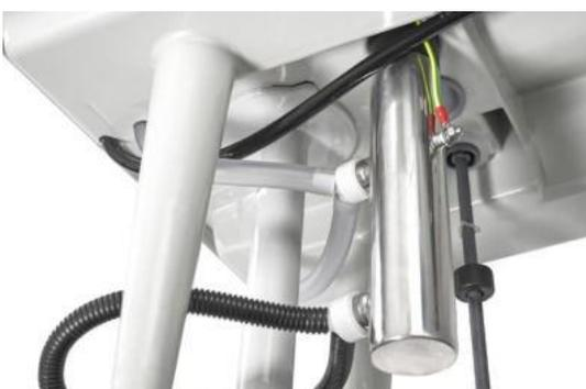
Abb. 8.1.2.8: UV-Entkeimungseinheit, komplett
