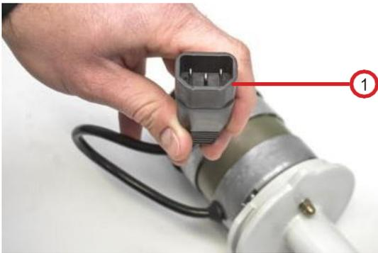
Abb. 7.4.1.7: Steckerverbindung lösen
